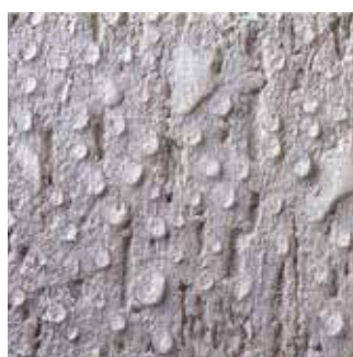
Vatten har inte en chans. Alsitop är genomgående hydrofobisk och puts-skiktet kan inte ta upp något vatten.
