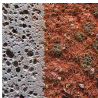
Genomgående mineralisk väggkonstruktion - Alsitop lättputs på lättbetong
